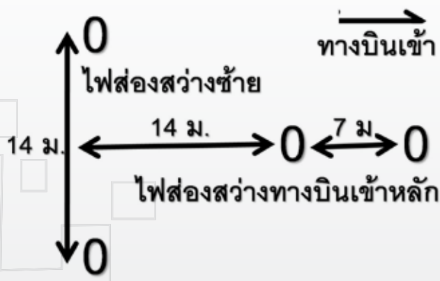
รูปที่ 6-46 ตัวอย่างการทำสนามกลางคืน ด้วยไฟสัญลักษณ์ตัว Y
