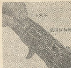
第74図 押上板腕を取り付ける
