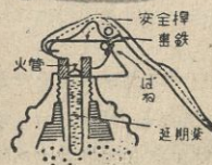
第134図 投げると撃鉄は安全桿をはずし火管を撃つ
