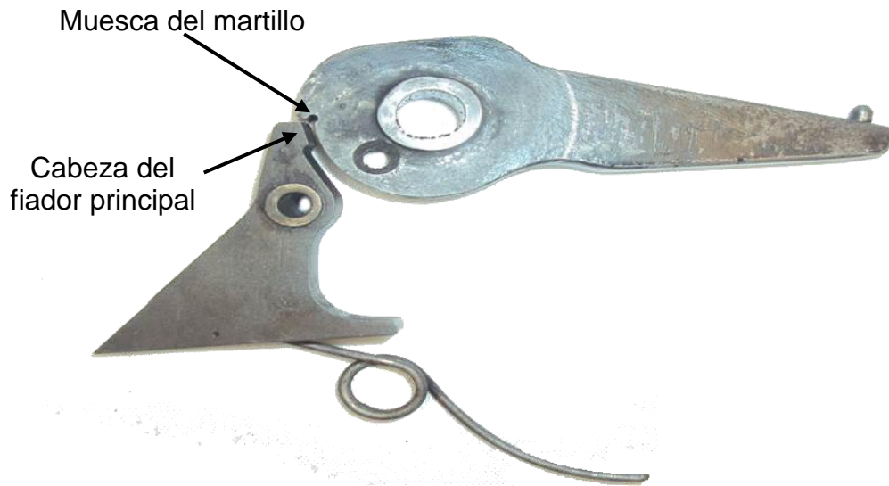
Figura Núm. 49 La cabeza del fiador principal asegura al martillo por su muesca
